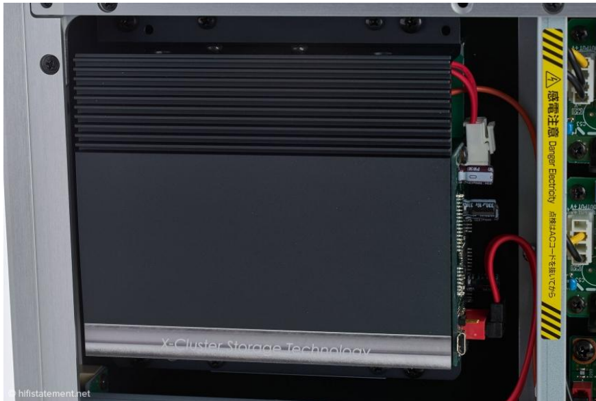
Unter der Abdeckung sind zwei SSDs mit jeweils 500 Gigabyte verborgen
