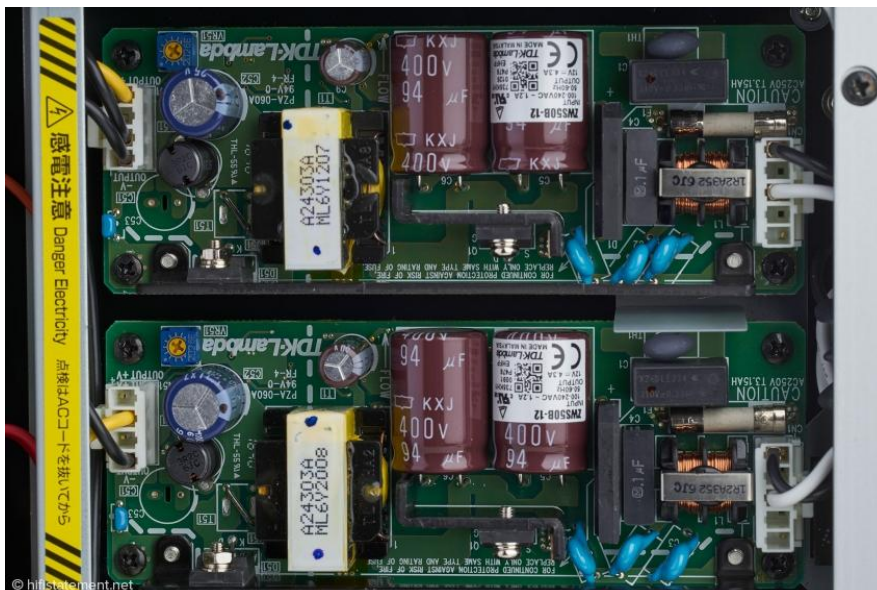
Die beiden Netzteile für die Festplatten sowie den System Block leisten je 50 Watt
